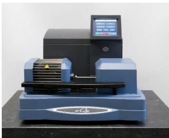
1.12 Сурет - SDT Q600 бір мезгілде TGA/DSC дериватографы
