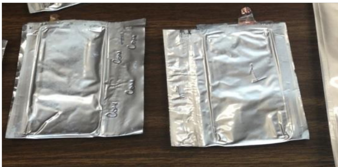
2.8 Сурет - Призмалық батареялардың зертханалық прототиптері
