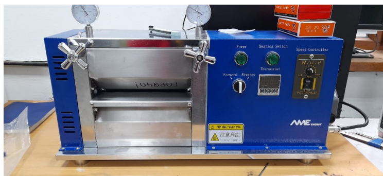
2.4а Сурет - жабын құрылғысы ; б. 50МПа жабынды илемдеу машинасы
